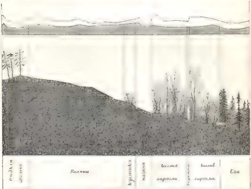
Черт. 92 Нивелировка снѣжного покрова въ дек. 1902 г. въ паркѣ Лиси Инст. (близъ Сиб.) Внизу — профиль мѣстности (вертикальный масштаб сильно увеличенъ сравнительно съ горизонтальными разстояніями, сверху — профили снѣга (заштрихованный — при первой, лицевой; при второй нивелировке).
